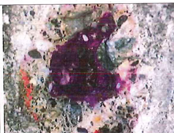
Aspect rapproché du sondage S1 armature verticale, Ø 8 mm type Caron enrobage 16 mm, non oxydée Front de carbonatation du béton : 8 à 12 mm Enrobage aciers voisins (mm) : 22 – 25 – 20 – 18 – 20 – 22 – 24 – 19 – 20 – 22 – 21
