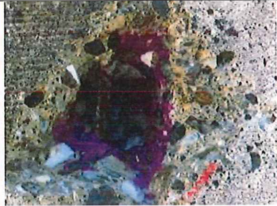
Aspect rapproché du sondage S6 armature verticale, \varnothing 6 mm type Caron enrobage 20 mm, légèrement oxydée Front de carbonatation du béton : 8 à 16 mm Enrobage aciers voisins (mm) : 24 – 26 – 20 – 22 – 21 – 19 – 20 – 21 – 22 – 22 – 25
