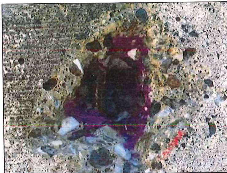
Sondage sur un acier non oxydé ayant un enrobage suffisant Couleur violacée : béton non carbonaté Couleur béton : béton carbonaté
