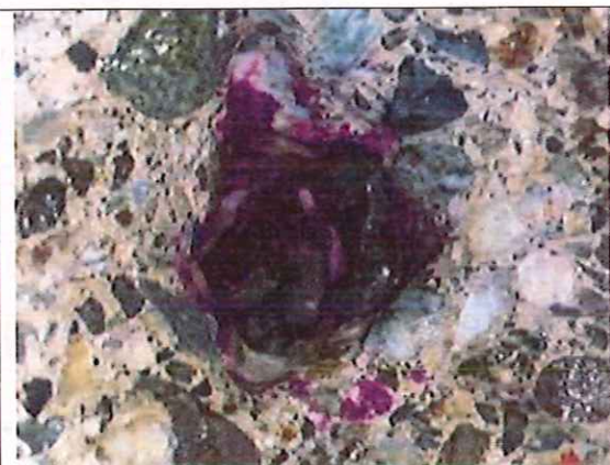
Aspect rapproché du sondage S5 armature verticale, \varnothing 8 mm type Caron enrobage 36 mm, non oxydée Front de carbonatation du béton : 10 à 20 mm Enrobage aciers voisins (mm) : 26 – 27 – 30 – 32 – 30 – 32 – 22 (aucune dégradation) – 8 – 12 – 15 – 13 (éclat de béton en formation au droit des aciers)
