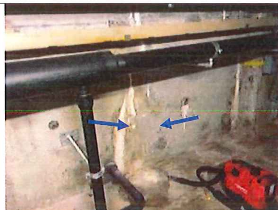
Prélèvement du CI 5 au droit d'une coulure avec résurgence sur mur périphérique du bassin de la piscine et CI 6 à 30 cm de CI 5 (sur zone visuellement saine)
