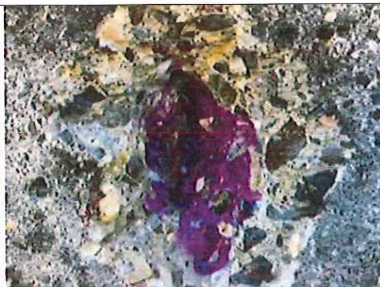
Aspect rapproché du sondage S4 armature verticale, \varnothing 8 mm type Caron enrobage 28 mm, légèrement oxydée Front de carbonatation du béton : 9 à 28 mm Enrobage aciers voisins (mm) : 22 – 25 – 26 – 25 – 24 – 24 – 25 – 25 – 25 – 25 – 24
