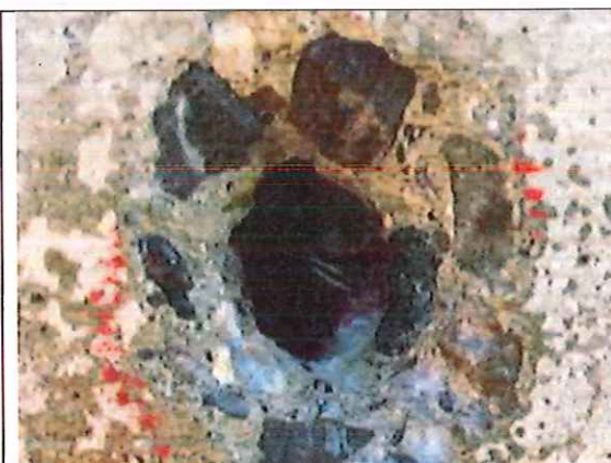
Aspect rapproché sur sondage S10 Front de carbonatation du béton : 2 à 4 mm Enrobage moyen des aciers (mm) : \geq 23 mm
