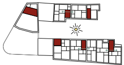
4 cages d'escalier naturellement éclairées depuis la cour de l'îlot pour 9 bâtiments
