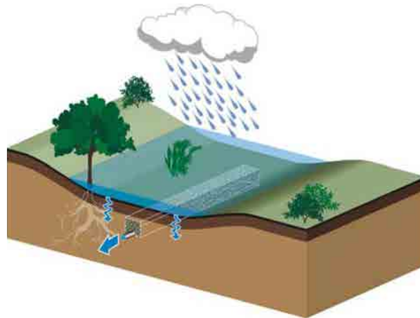
Noue mixte, à la fois infiltrante et drainante, sur un sol moyennement perméable. Source Architecture & Climat
