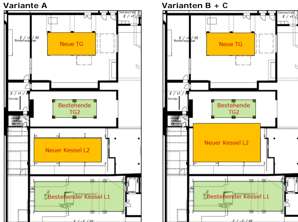
Abbildung 3: Schematische Darstellung der Umsetzung der Varianten. Variante A links und breiterer Kessel der Varianten B und C rechts im Bild. Bestehende TG2 wird rückgebaut.
