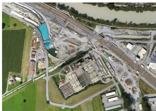
Luftbild des Vollanschlusses Visp West: Die Phasen der Unterwasserbauarbeiten unterscheiden sich farblich: Im hellen Wasser der nördlichsten Baugrube ist der Unterwasserbeton eingebracht. Im mittleren Feld ist er in Ausführung; im südlichsten Feld findet der Unterwasseraushub statt (braunes Wasser).
