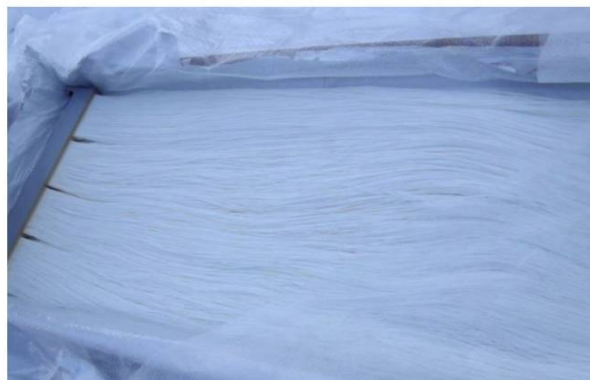
Photo 2: Module de membranes du ZW500 constituées de fibres creuses
