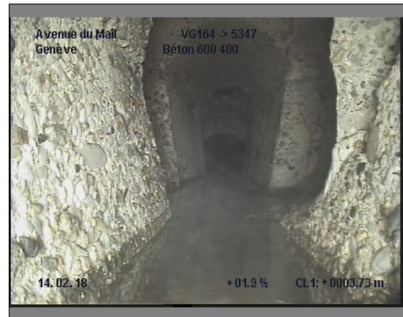
Photo: 9_9_66_A.JPG, 00:02:21 3.7m, Fissure(s) à 09 h.
