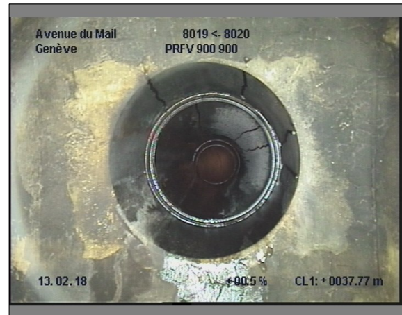
Photo: 6_6_34_B.JPG, 00:04:05 37.7m, Branchement à 12 h.
