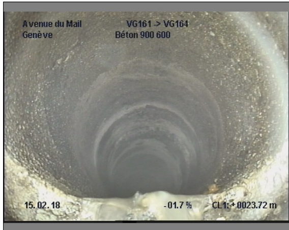
Photo: 14_14_265_B.JPG, 00:03:59 23.7m, Branchement à 09 h., pas crépi
