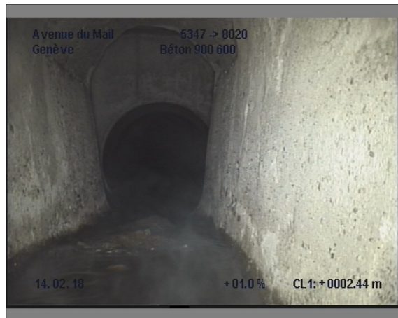
Photo: 10_10_74_A.JPG, 00:01:32 2.4m, Dépôt sur le radier
