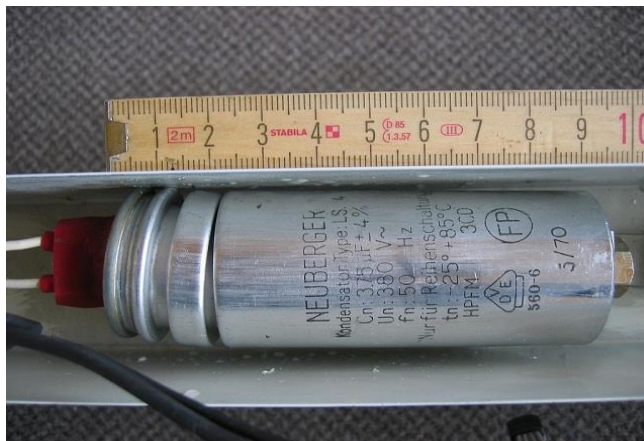
Abb. 5: Kondensatoren: Ein typisches Anwendungsfeld von PCB
