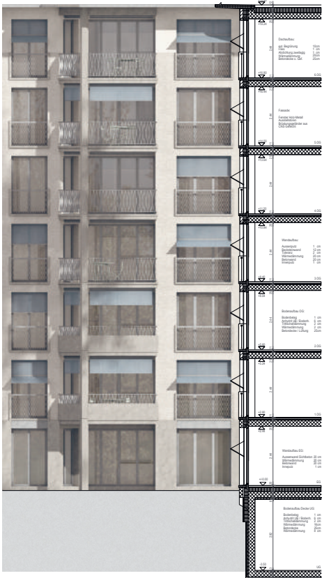
Fassadenschnitt und Fassadeansicht
