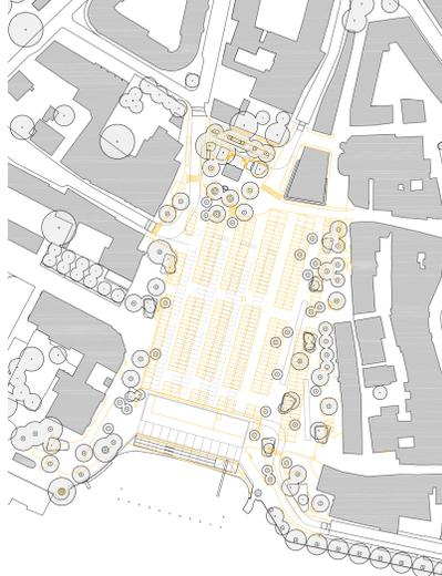
Les principaux éléments démolis sur la place sont en premier lieu le revêtement en enrobé bitumineux, les chaussées et les bordures remplacés par le pavage. Les gradins en béton remplacent le perré en pierre. Le mobilier existant est remplacé par les bancs circulaires en bois.
