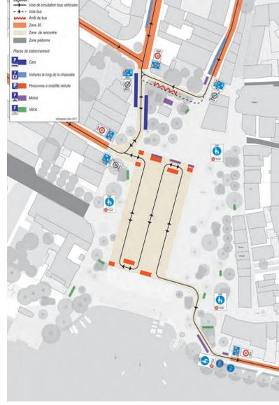
Le schéma de circulation comprend deux grandes modifications par rapport à la première phase de projet. La circulation de la rue de Lausanne est déviée au nord du kiosque du Bois d'Amour afin de libérer la place de la présence des véhicules. Deux voies sont réalisées, l'une réservée aux transports publics et l'autre pour les transports individuels et les cars.
