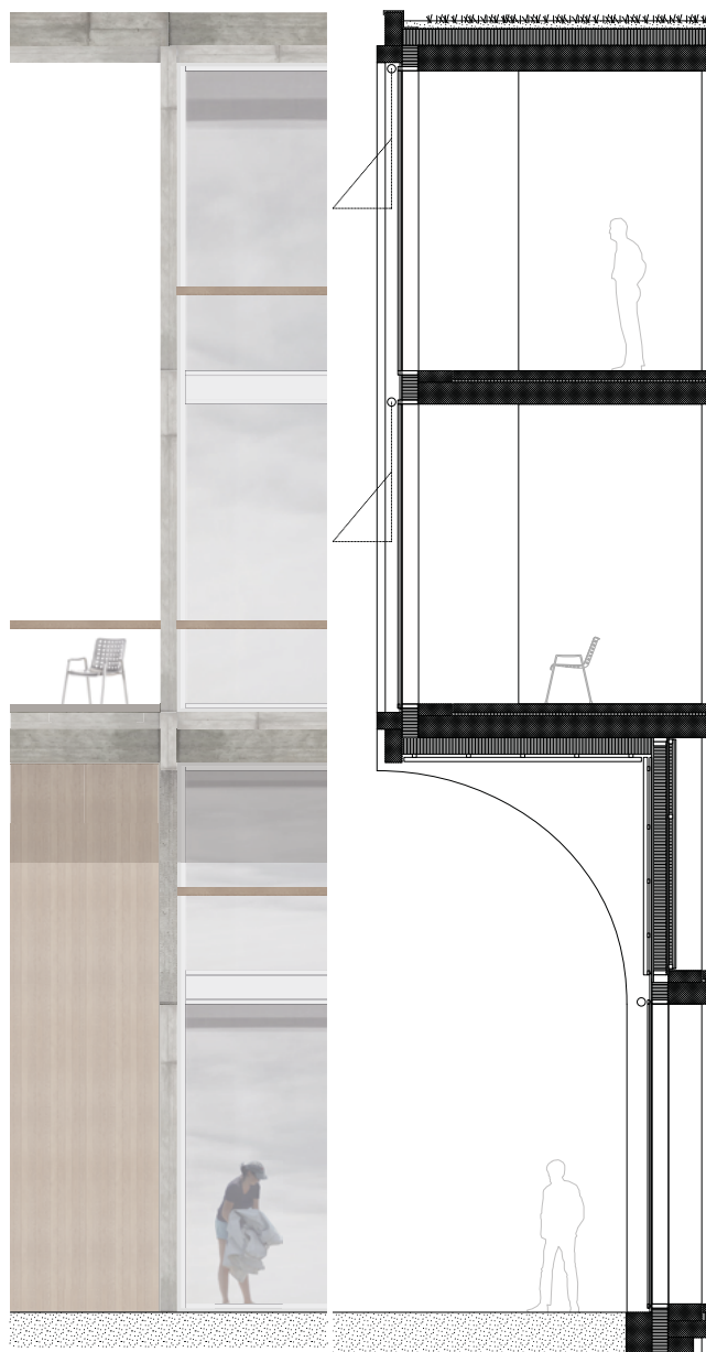
Konstruktionsschnitt und Ausschnitt Fassade 1:100
